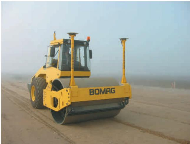
Abb. 2: Baumaschinensteuerung (Abbildung mit freundlicher Genehmigung der Firma BOMAG GmbH, Boppard)
